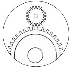
5. Les noms des différentes parties de ce modèle sont : **Manivelle, engrenage de commande, engrenage entraîné, et les pales du ventilateur.** Utilisez du ruban adhésif pour étiqueter les différentes parties de votre modèle.
