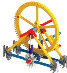
(c) Pensez à une façon de comparer la vitesse que le ventilateur tourne, avec la vitesse de la manivelle lorsque le grand engrenage est fixé à la manivelle et le petit engrenage est fixé aux pales du ventilateur.
